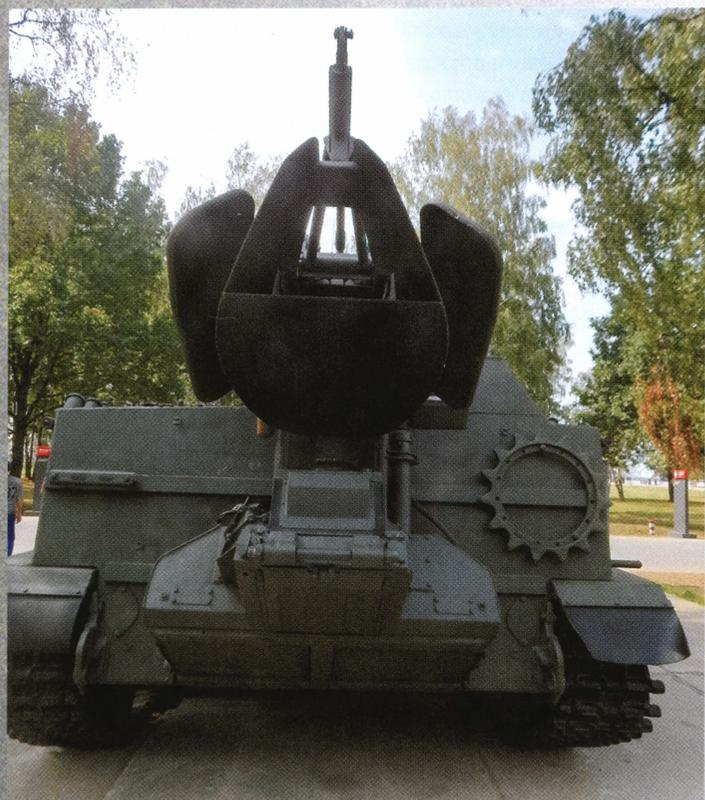
Гусеничный минный заградитель ГМЗ-3, вид сзади. Плужное приспособление для установки мин поднято (в походном положении).
