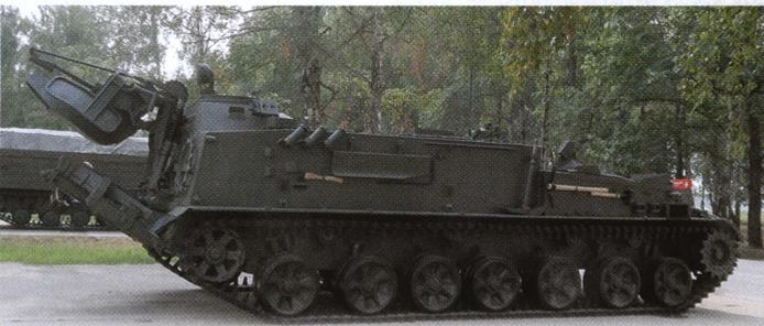
Гусеничный минный заградитель ГМЗ-3, вид справа. Хорошо видна укладка инструмента на борту машины (топор, лом, кирка кувалда).
