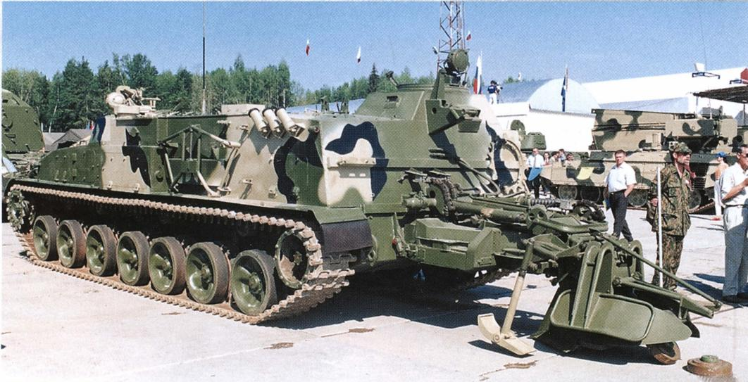
Гусеничный минный заградитель ГМЗ-3, вид сзади слева. Плужное приспособление для установки мин опущено (в рабочем положении).
