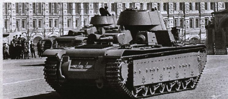
Танк Т-35 с коническими башнями (выпуска 1939 года) на Красной площади, 1 мая 1941 года. Машина имеет наклонную подбашенную коробку и другую форму люков в фальшборте.
